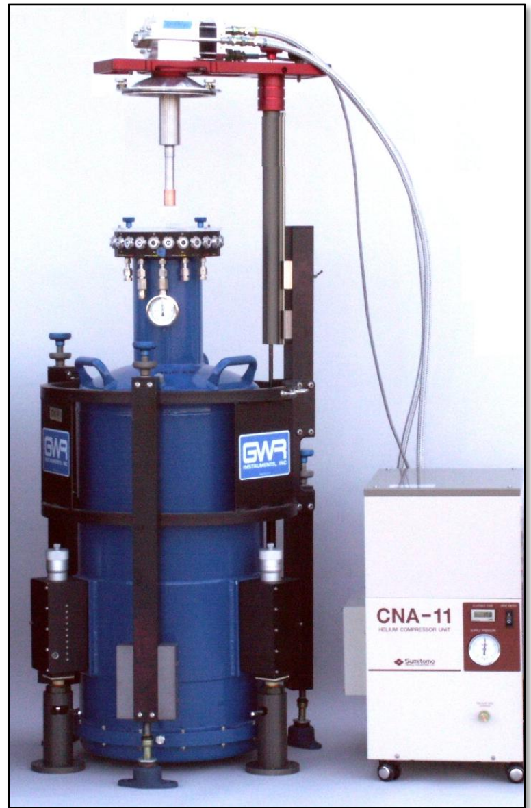
OSG的杜瓦，隔振架和coldhead低温制冷机
