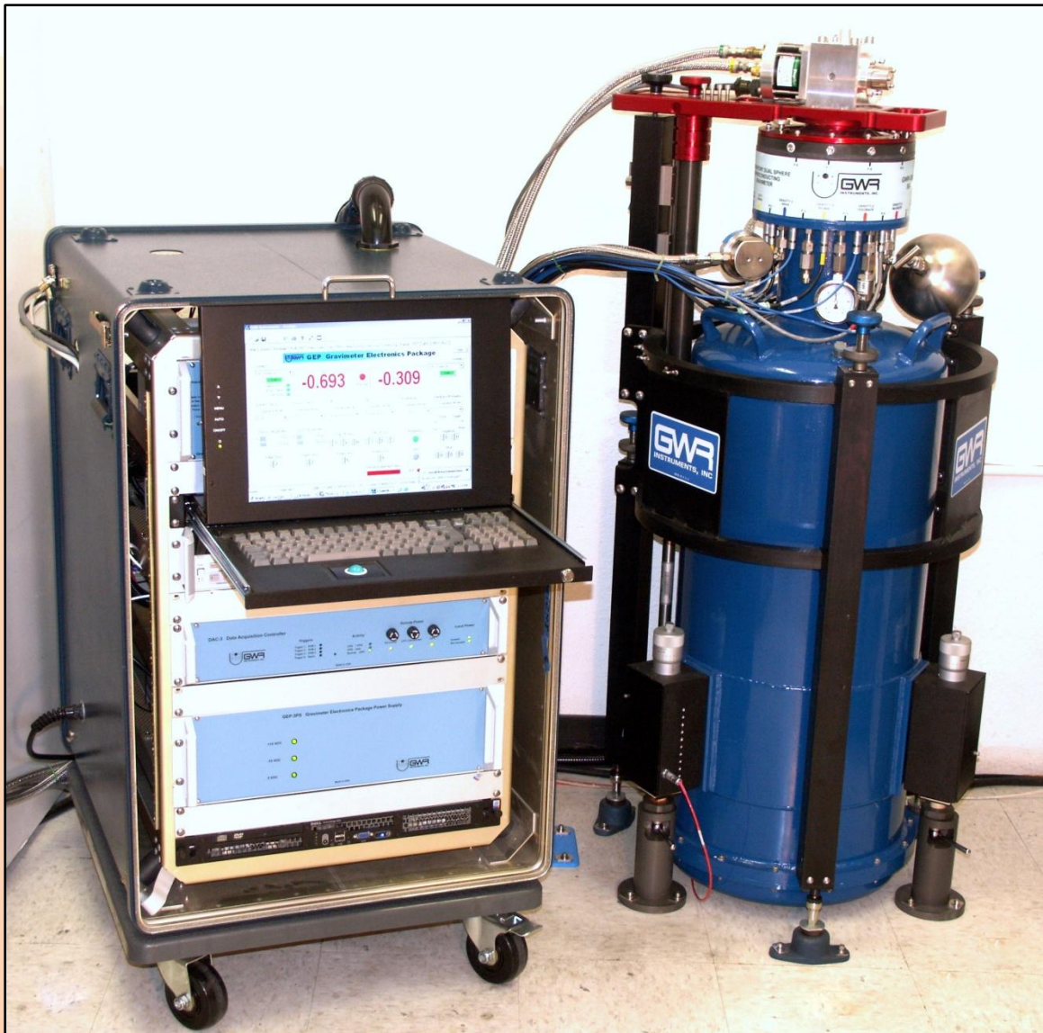
台式超导重力仪（OSG），电子设备和4K制冷系统
